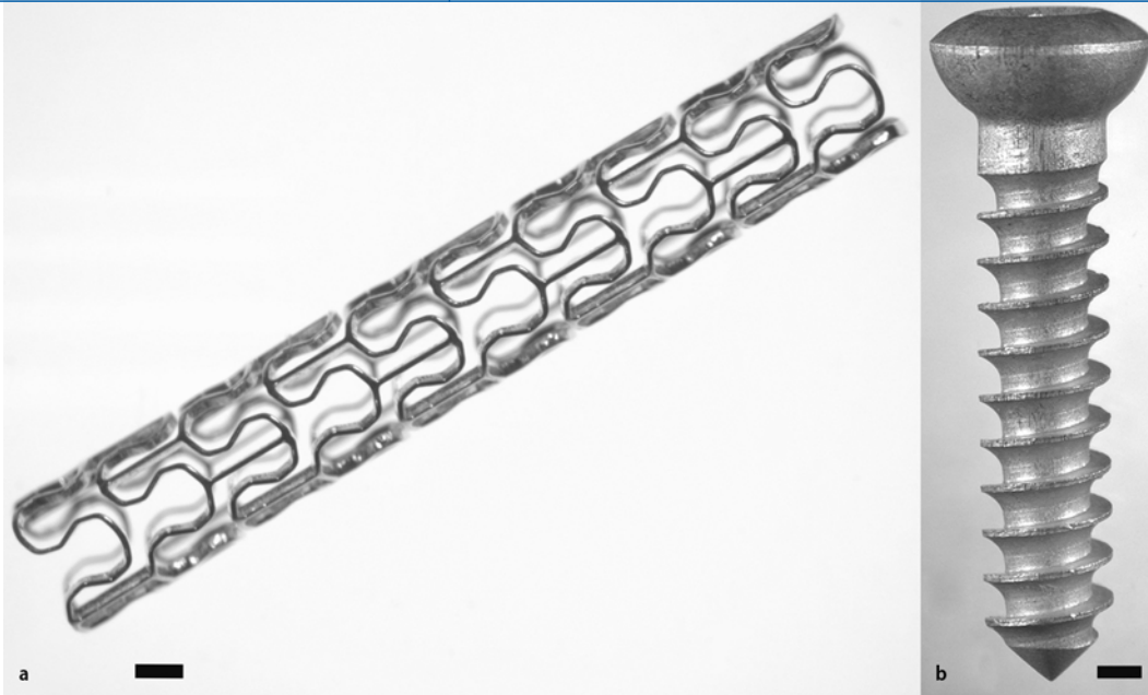
Abb. 2 ◀ Biodegradable Metallimplantate aus Magnesiumlegierungen. a Eine kommerziell erhältliche Gefäßstütze der Firma Biotronik. b Eine für die Forschung produzierte Kortikalisschraube. Der Maßstabsbalken entspricht 1 mm
