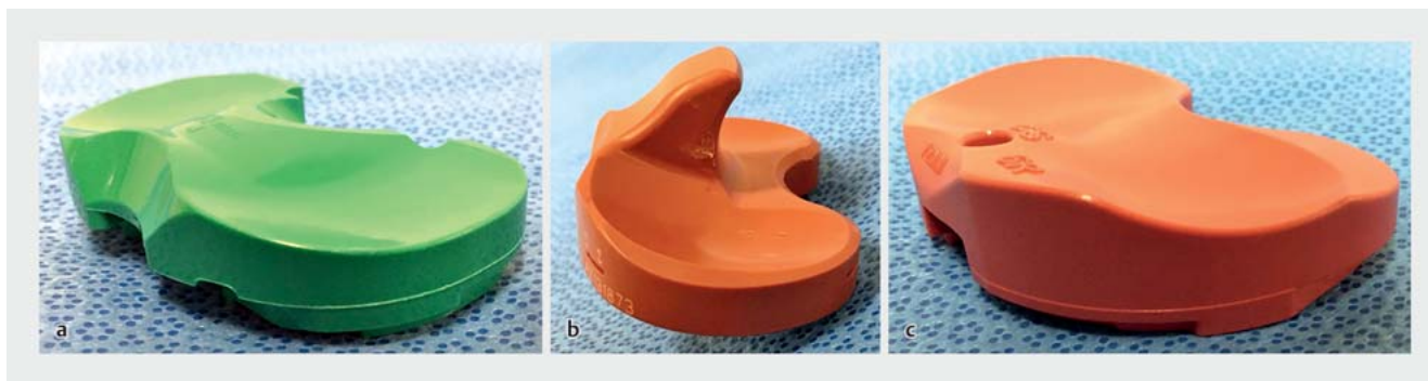
► Abb. 4 Darstellung unterschiedlicher Inlaykonformitäten und Designprinzipien: a niedrig konformes Inlay mit hoher Rotationsfreiheit. b Mobile Bearing (posterior-stabilized) Inlay mit hoher Konformität. c Medial Pivot Inlay mit hoher Kongruenz medial und niedriger Kongruenz lateral.
